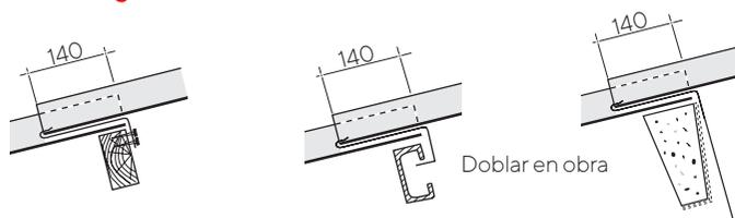
Sobre correas de madera, metálica y de concreto.
