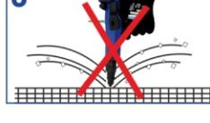
Nunca fije nada en material base de concreto de un espesor inferior a 3 veces de la longitud de penetración del clavo.
