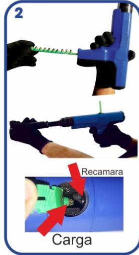
**NOTA: Es peligroso aplicar una fuerza excesiva al introducir el clavo en acero o concreto**
