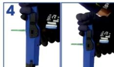
**5** Nunca fije un clavo demasiado cerca de otro o de un borde liso, esto puede causar un rebote del clavo.
