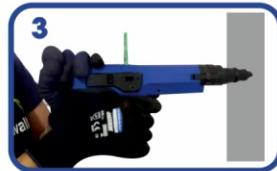
**PRECAUCIÓN:** Si la herramienta no dispara después de halar el gatillo, manténgala firmemente puesta contra el material por 30 segundos. Retirela del material de trabajo y abra el barril para reajustar el pistón.
